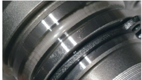
图 1 因轴承电腐蚀产生的“搓板纹”
