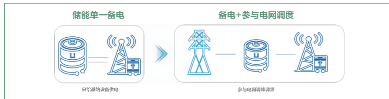
图：储能由单一备电走向备储一体
