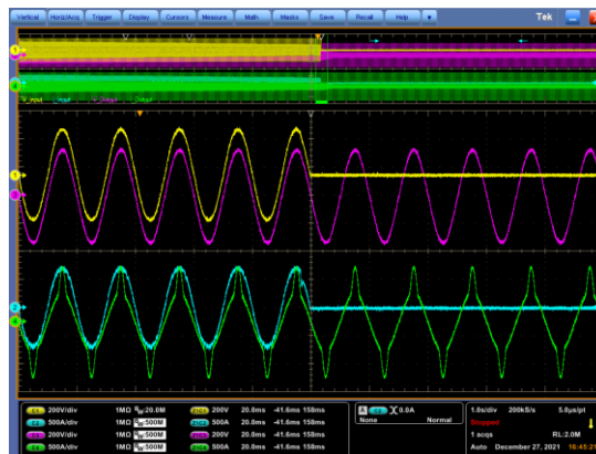
图44 黄色:旁路输入电压, 蓝色:旁路输入电流, 紫色:系统输出电压, 绿色:系统输出电流
