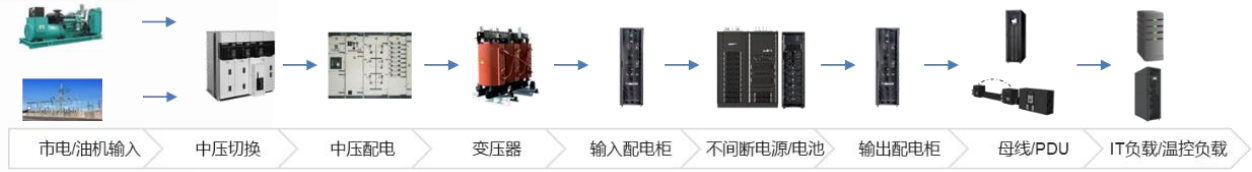
图1 数据中心供电核心系统
