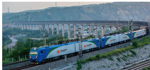
(世界首台24轴最大单机功率电力机车)
