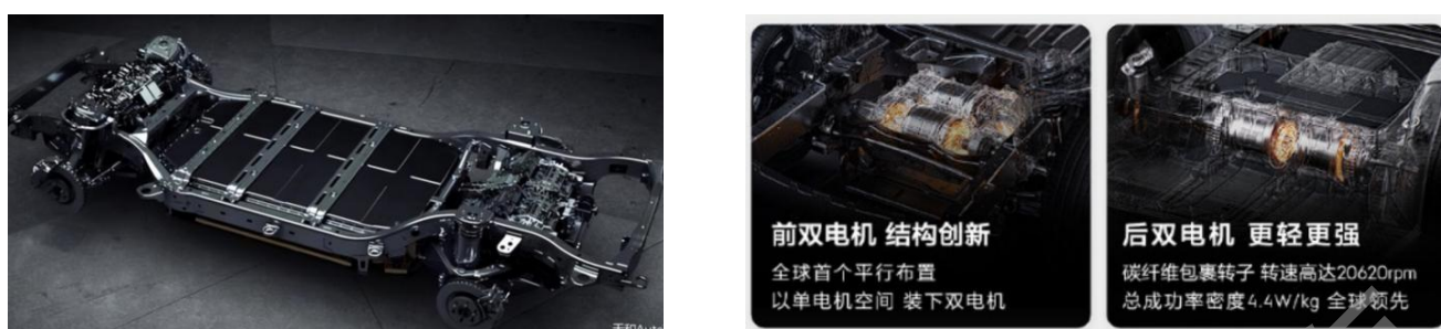
图 12 高性能越野四电机分布式驱动构型、超跑车型四电机驱动构型
