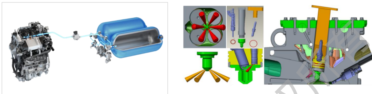
图 10 热效率 46%氢动力系统、氨气燃料喷射系统
