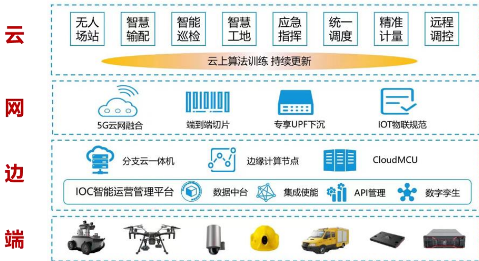
基于 5G 网络云边端协同架构
