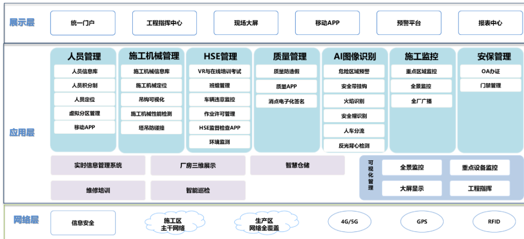
国和一号基于 5G 的智慧工地系统架构
