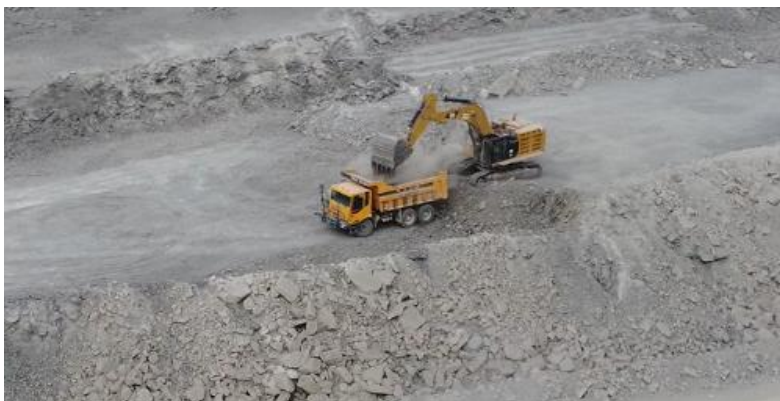
矿用宽体车和挖机精准对位
